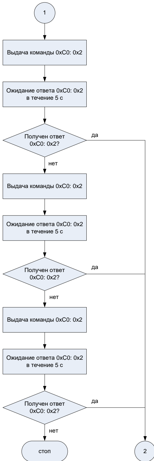
Рис. 3. Процедура перевода приемника в режим обновления ПО
