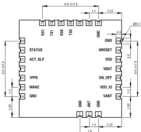
Рис. 5. Чертеж контактных площадок
