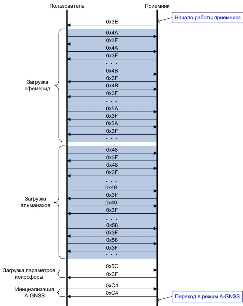
Рис. 3. Последовательность загрузки ассирирующей информации
