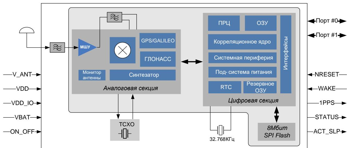
Рис. 1. Структурная схема
